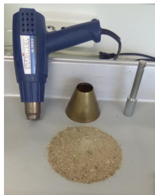
Fig. 2.2 – Essai d’absorption du sable (selon la norme EN 1097 – 6)
