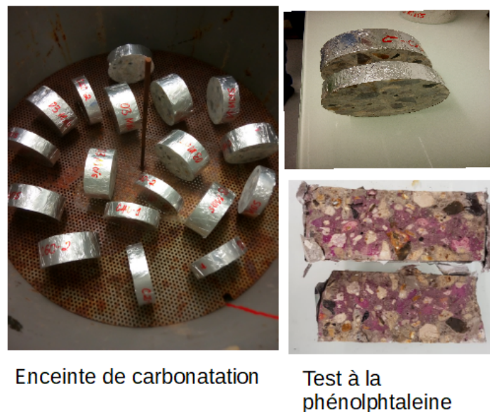
Fig. 2.12 – Dispositif d'essai et préparation des échantillons.
