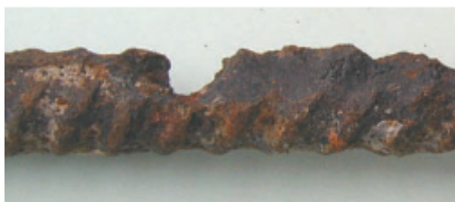
Fig. 1.9 – Piquûre de corrosion (localisée) due aux ions chlorures.
