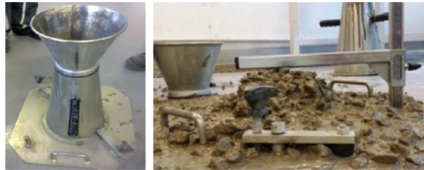
Fig. 2.5 – Essai d'affaissement au cône d'Abrams
