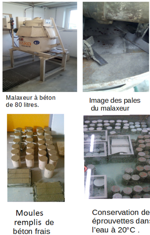
Fig. 2.4 – Mise en éprouvette et conservation du béton
