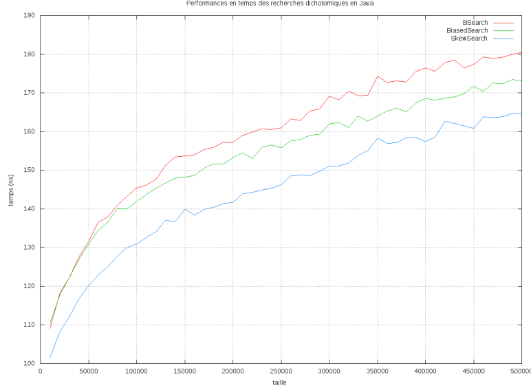
FIGURE 5.9 – Courbes de performances de temps mesurées sur les implantations Java des variantes de la recherche dichotomique.
