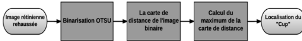
FIGURE 3.10: Processus de localisation d'un point de référence dans le disque optique.
