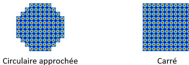
Figure II-9 : Champs proches avec une pupille circulaire (à gauche) et carrée (à droite)
