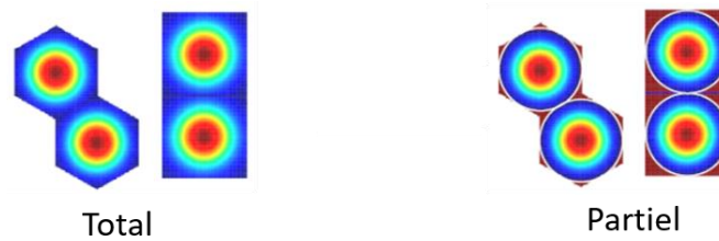
Figure II-11 : Sous-pupilles en champ proche avec remplissage total et partiel
