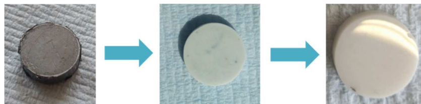
Figure 21 : Photos de pastille SPS a) encore enrobée de Papyex © juste après le démoulage, b) après avoir enlevé le Papyex © par polissage et c) après un polissage fin.
