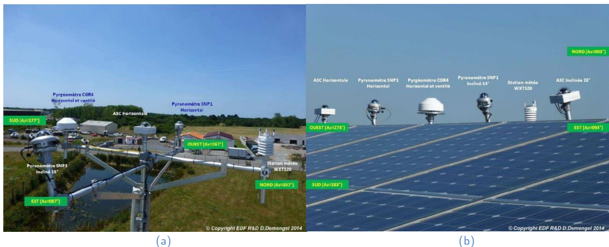
Figure 7 – Photos des appareils de mesure qui équipent le site n°1 (a) et le site n°2 (b). ASC : caméra hémisphérique ; pyranomètre SPN1 : instrument de mesure du rayonnement global et diffus.
