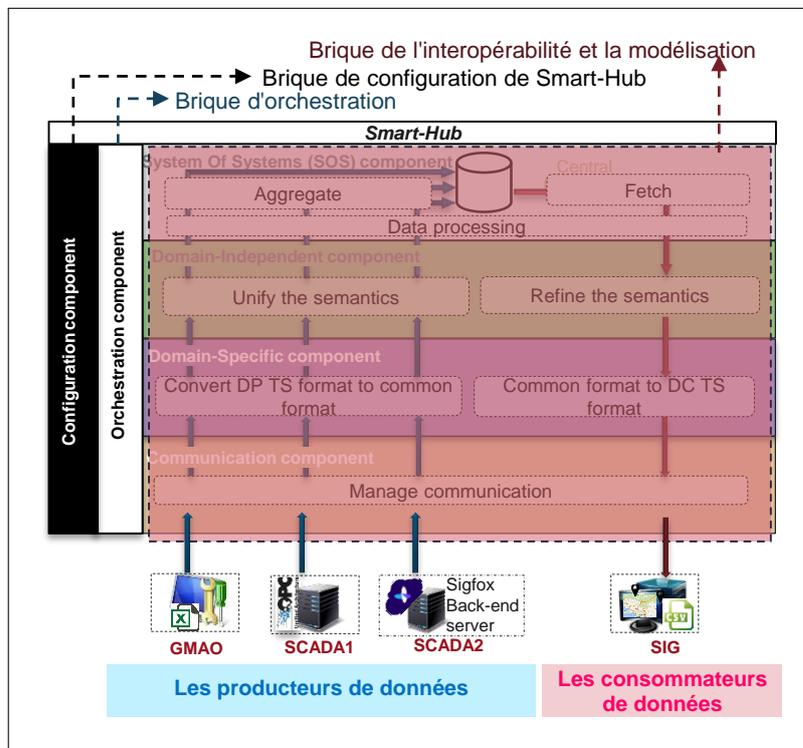
FIGURE 4.2 – Vue globale des briques d'implémentation
