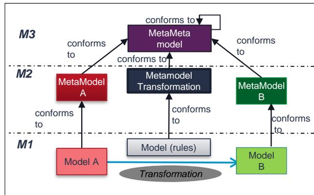
FIGURE 2.25 – le processus de transformation du modèle
