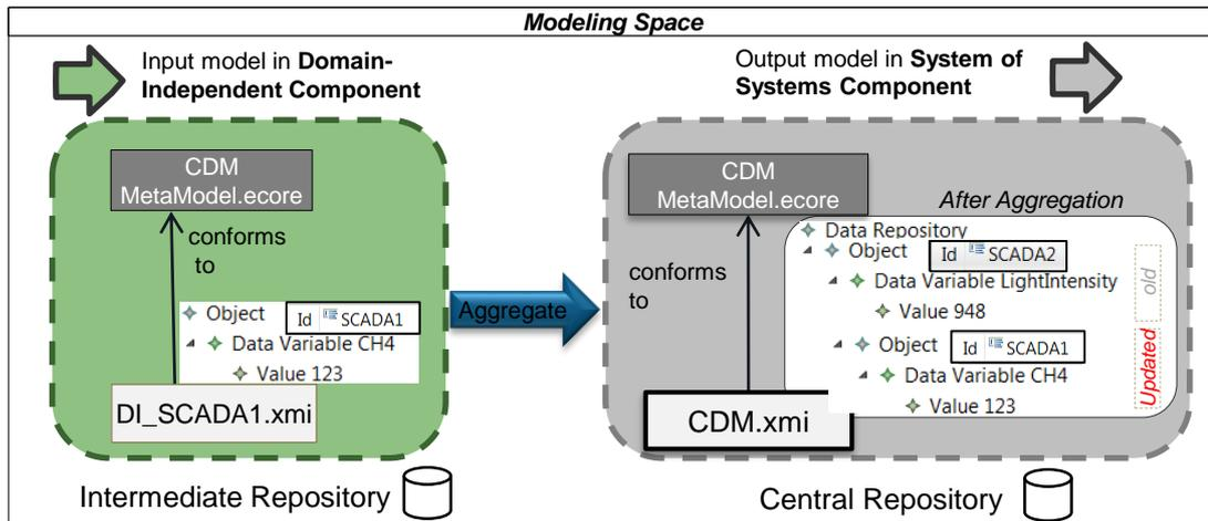
FIGURE 4.9 – L'agrégation des données de SCADA1
