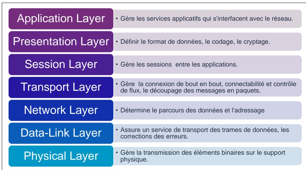
FIGURE 2.1 – Modèle OSI
