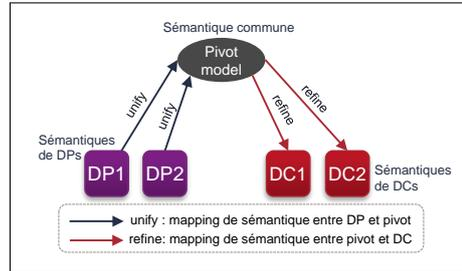
FIGURE 3.6 – L’approche unification dans le SH
