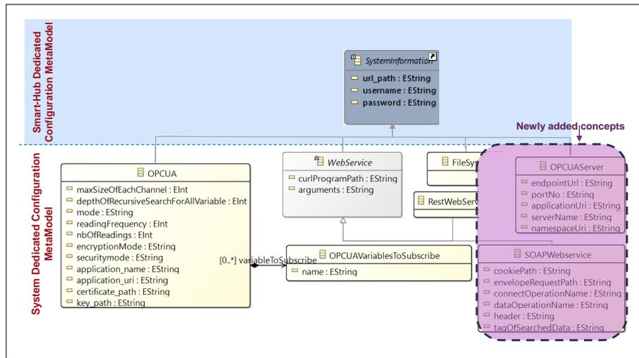
FIGURE 5.7 – Le métamodèle de configuration spécifique au système externe étendu "System Dedicated Configuration MetaModel"
