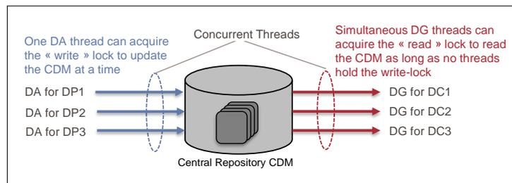
FIGURE 4.14 – La simultanéité des processus de DA et DG
