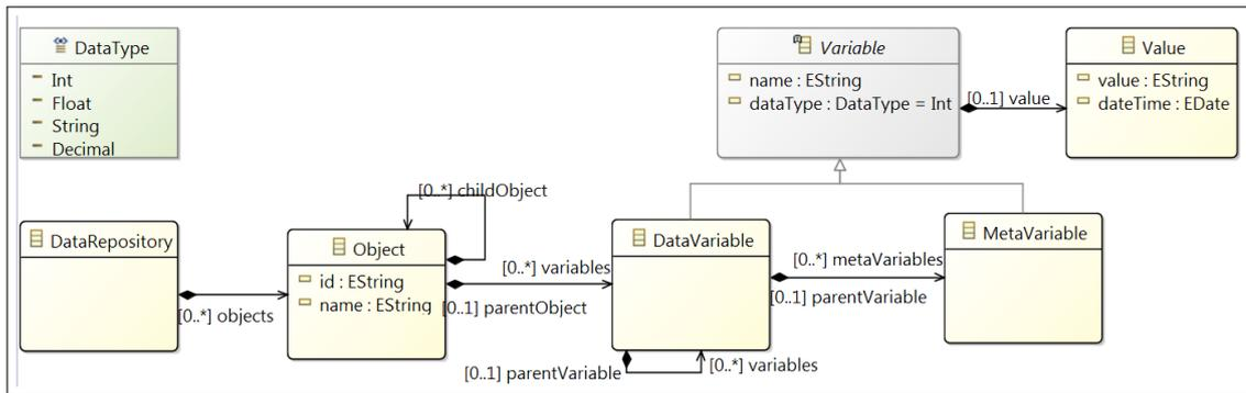
FIGURE 4.6 – Modèle de données "Common Data Model"
