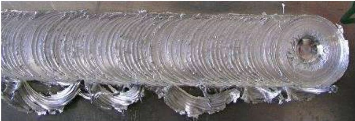
Figure 1.20 : Défaut de soudage externe dit « Flash » qui correspond à un surplus de matière [42].
