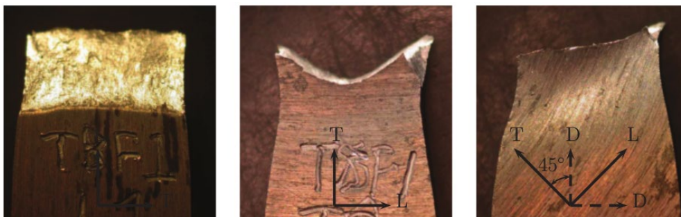
Figure 1.16 : Faciès de rupture macroscopiques pour des essais de traction sur le métal de base 2198-T8 sollicité dans les trois directions L, T et D [20].
