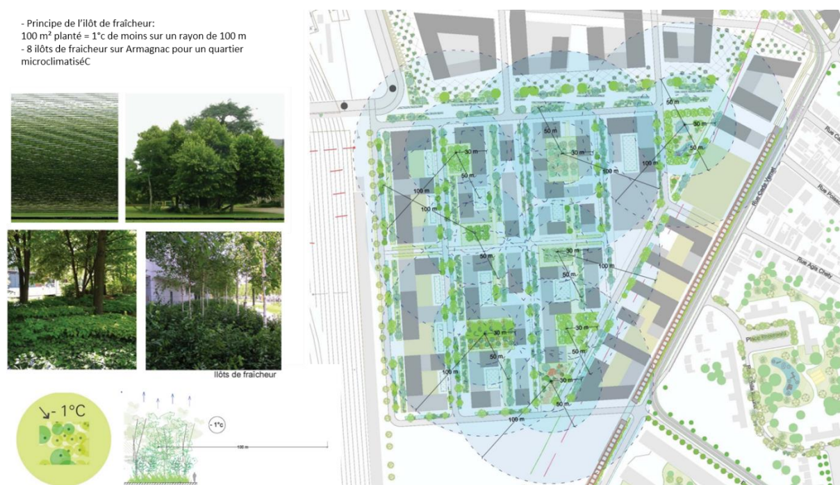
Figure V-16. Principe des îlots de fraîcheur du domaine Armagnac Extrait d'une présentation au Comité de pilotage de Bordeaux Saint-Jean Belcier, octobre 2011
