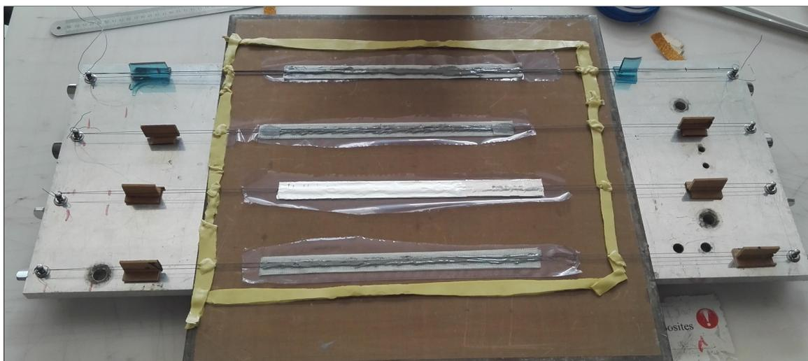
FIGURE 4.4.1 – Bâti pour la cuisson des composites avec pré-étirement de fils AMF
