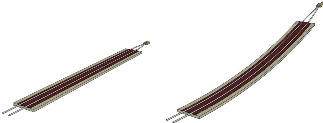
FIGURE 4.4.4 – Lame A et B : Fabrication à plat, et configuration courbée lors du chauffage
