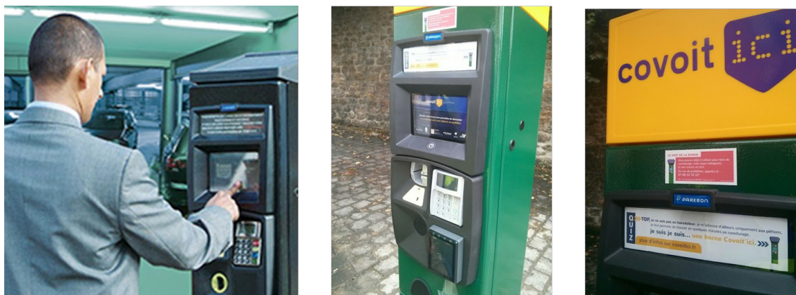
Illustration 20 : Illustrations de la borne de covoiturage. De gauche à droite : photo du modèle d'horodateur détourné pour concevoir la borne (Source : https://www.parkoon.fr/innovation/ , consulté le 16/08/2018) ; deux photos de bornes covoit'ici (Source : ecov).
