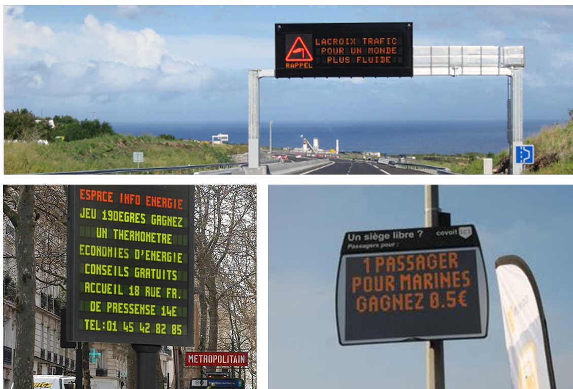
Illustration 28 : Illustrations de panneaux à messages variables. De haut en bas, de gauche à droite : photo de PMV sur l'autoroute (Source : http://www.lacroix-city.com/fr/france/produits/trafic-interurbain/panneaux-a-message-variable/ , consulté le 16/08/2018) ; photo de PMV en zone urbaine (Source : https://www.citelum.fr/nos-services/gamme-communication-et-information/panneaux-a-messages-variables , consulté le 16/08/2018) : photo de PMV covoit'ici (Source : https://www.construction21.org/france/infrastructure/fr/covoit-ici-service-public-de-covoiturage-de-proximite.html , consulté le 16/08/2018).
