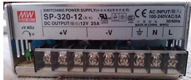
Figure 45 - Gauche : Potence et positionnement des lampes halogènes pour l'éclairage des objets. Droite : convertisseur de courant 220V AC vers 12V DC
