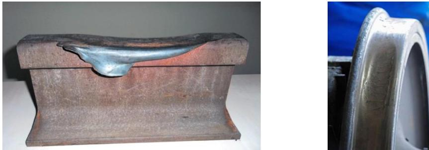
Figure 11 – Gauche : Rail fondu suite à un patinage important. Droite : Roue « plate » suite à un enrayage important. Source SNCF.
