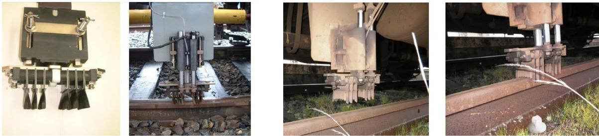
Figure 12 – Brosses métalliques, montées sous un train. Gauche : brosse droite. Droite : brosse adaptées à la courbe du champignon de rail.
