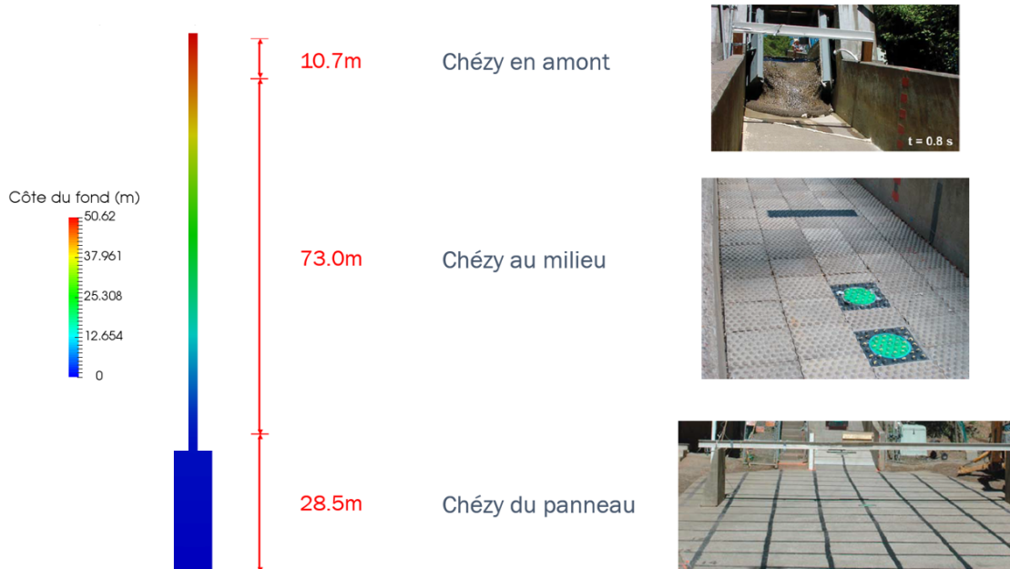
Figure 4.3: Spatialisation de frottement dans le modèle numérique.
