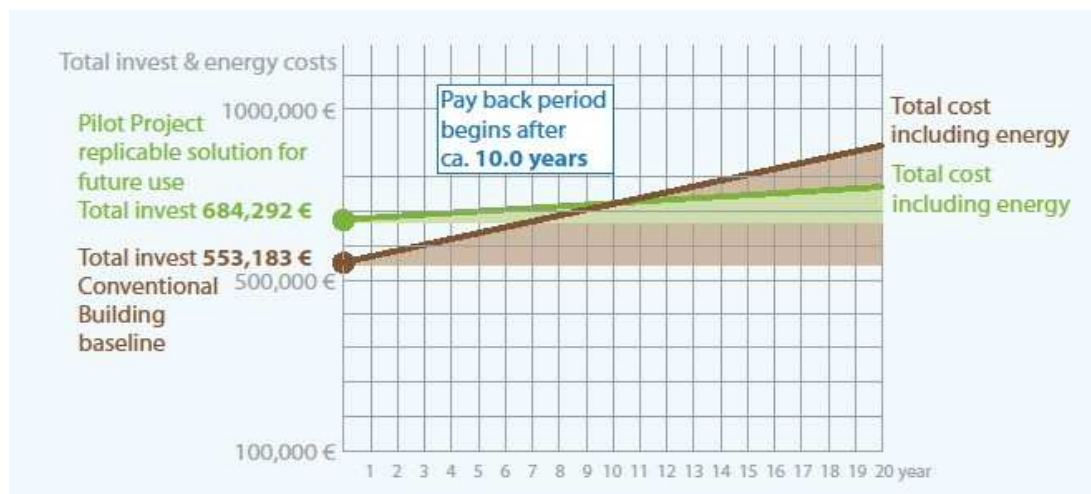
Figure 42 Diagramme des coûts d'investissement et d'énergie pour le projet Med-ENEC pour une durée d'exploitation de 20 ans par rapport à un bâtiment conventionnel. ( http://www.med-enec.org , 2012)
