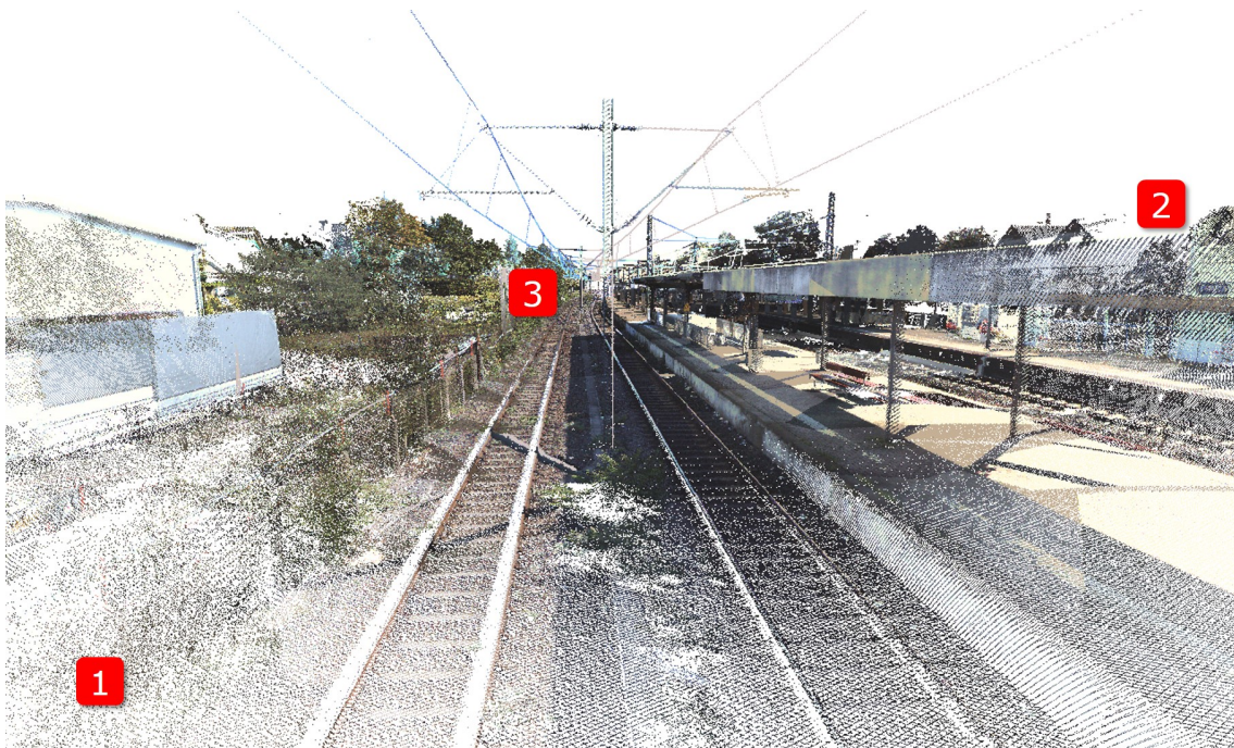
FIGURE 1.4 – Principaux artefacts observables en rendu de nuages de points. (1) Proche du point de vue, la densité du nuage de points projeté sur l'image est trop faible. (2) On peut voir à travers le modèle. (3) Aliasing.
