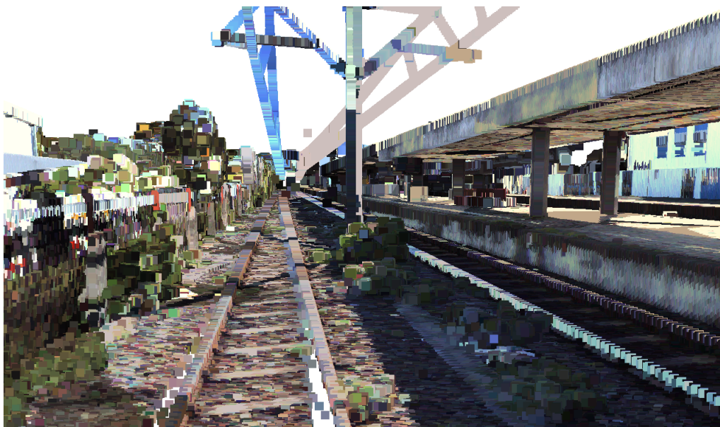
FIGURE 1.12 – Rendu par grossissement de la taille des points. La taille des points est fixée à 15 pixels pour une résolution de 1280 \times 748
