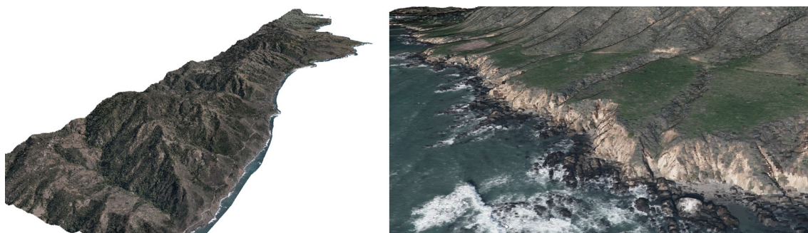
FIGURE 1.2 – Vues d'un nuage de points de la côte de la ville de San Simeon en Californie, obtenues à l'aide du logiciel Potree. Le nuage de points contient 17.7 milliards de points. Les données sont issues du site Open Topography .
