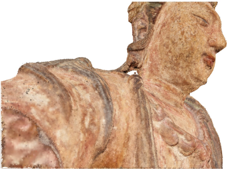
FIGURE 1.52 – Même modèle que la figure 1.51 rendu par la méthode proposée. Ici le rendu est réalisé par interpolation de la couleur de chaque point par l'algorithme de pull-push.
