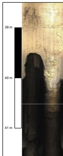
Figure 1-17 Photo d'une paroi de forage obtenue par imagerie optique lors de campagnes de diagraphies sur le site d'étude
