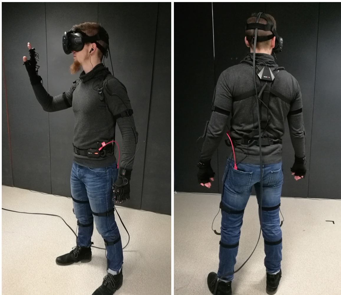
FIGURE A.4 – Combinaison sans fil Perception Neuron constitué de 32 capteurs inertiels (gyroscopes 3 axes, accéléromètres 3 axes et magnétomètres 3 axes) et cadencé à 60 Hz.
