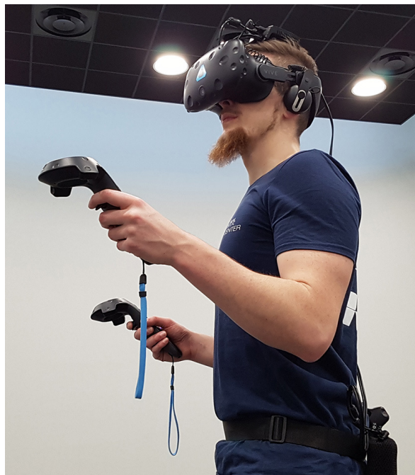
FIGURE 6.4 – Utilisateur équipé avec le matériel requis pour l'expérimentation : casque de réalité virtuelle HTC Vive et adaptateur sans fil TP Cast, Vive Trackers.
