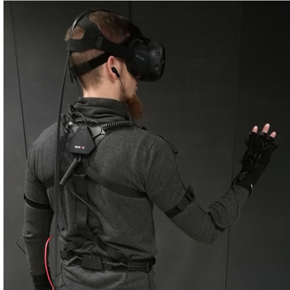
FIGURE 4.4 – Utilisateur équipé du matériel requis pour l’expérimentation : casque de réalité virtuelle HTC Vive et combinaison de capture de mouvement Perception Neuron.
