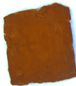
Figure IV-58 : cliché d'un échantillon préalablement vieilli 333h à 150°C dans l'air et 6000h d'immersion dans l'eau distillée à 70°C
