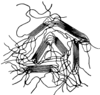
Figure I-1 : schéma d'une structure semi-cristalline [1]
