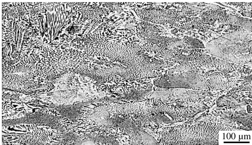
**Figure 10.26** – Microstructure d'un lingot d'alliage 720 (diamètre initial 500 mm) en cours de conversion. Des eutectiques lamellaires  $\gamma$ - $\gamma'$  sont visibles. Figure tirée de [6].
