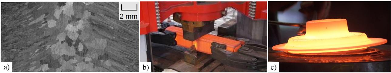
**Figure 3** – Illustration de la voie conventionnelle "coulé-forgé". a) Microstructure d'un lingot d'alliage 718 brut de coulée ESR, coupe longitudinale. Figure tirée de [6]. b) Forgeage d'un lingot dans une presse hydraulique. c) Pièce en fin de matriçage.
