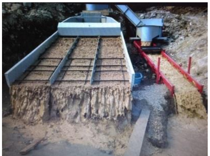
Figure 6 : Sluice industrielle, crédit RMS - Ross
