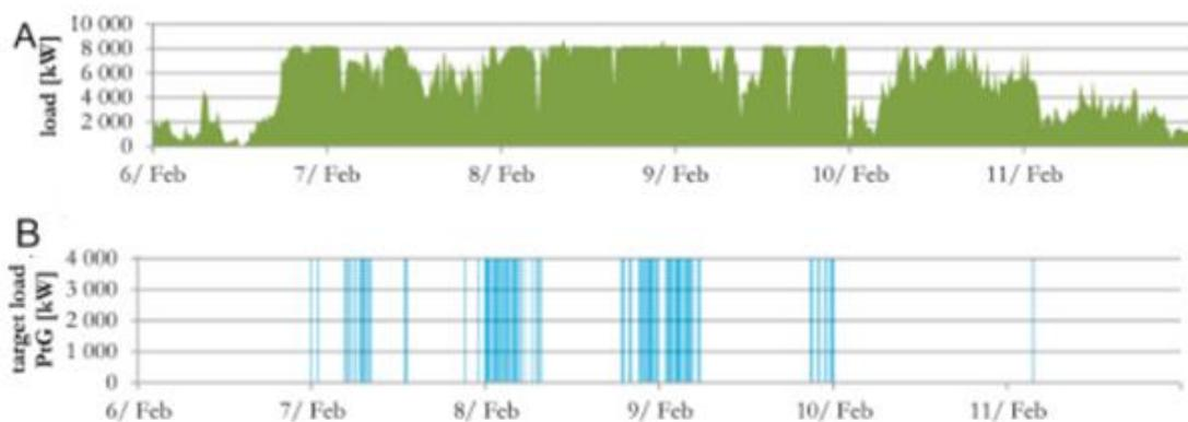
**Figure 1.6**– Exemple de planification des périodes de fonctionnement de l'installation, A : prévisions de la production du parc éolien, B : planification du profil de charge (Kopp *et al.*, 2017)
