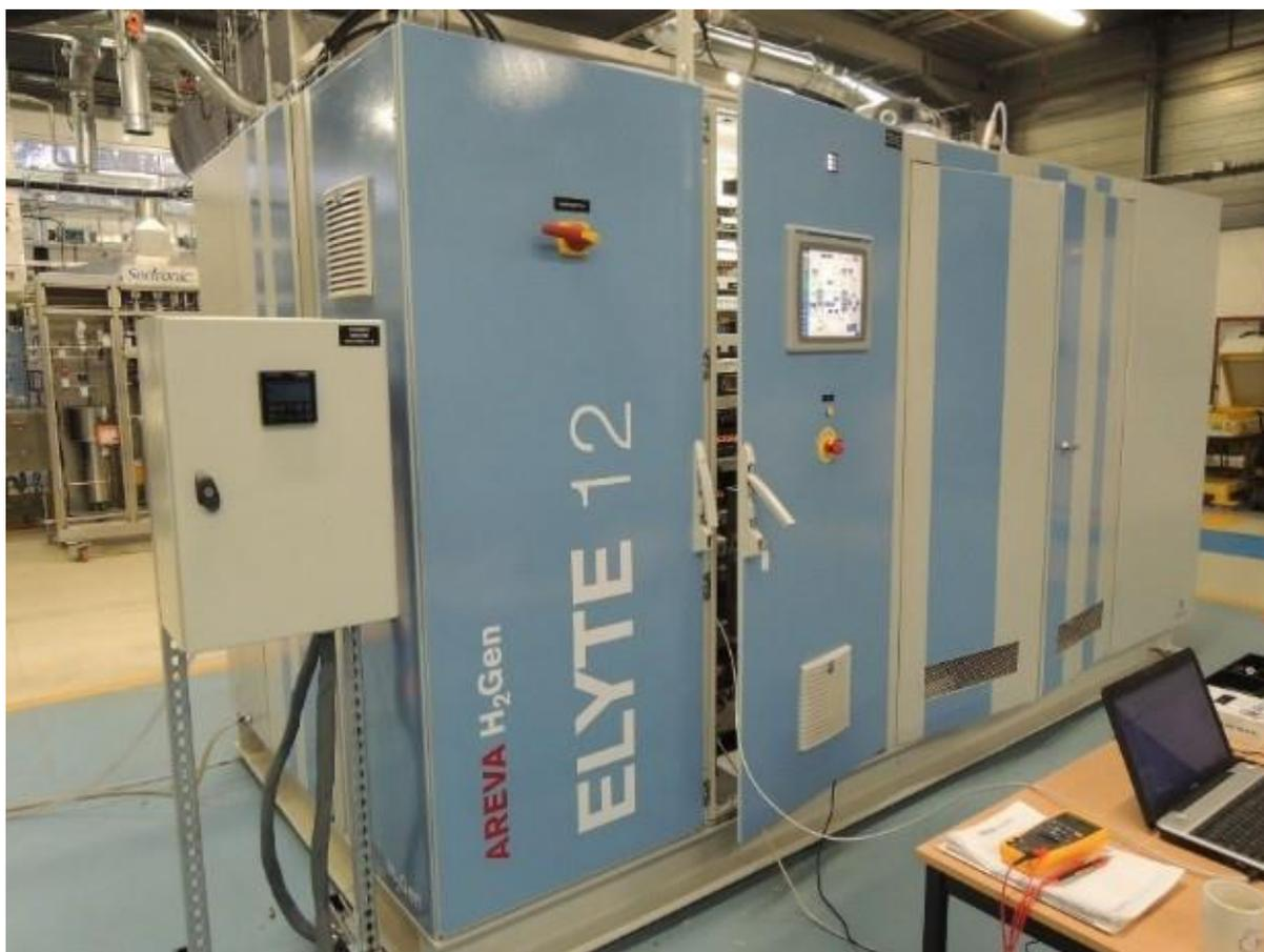
Figure 3.1– Aperçu du banc d'essai électrolyseur E12
