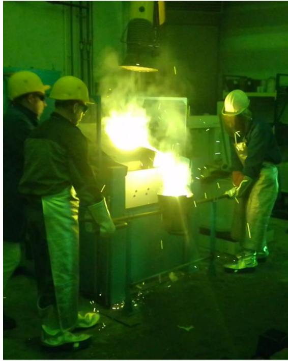
Figure III-24 : Transfert de l'acier liquide en poche de coulée
