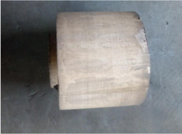
Figure III-14 : modèle en bois de la masselotte
