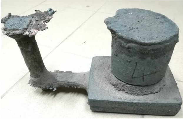
Figure III-7 : Lingot brut de coulée
