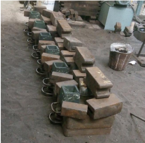
Figure III-20 : Disposition des moules avant fusion
