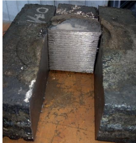
Figure III-8 : Coeur d'un lingot
