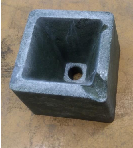
Figure III-16 : Entonnoir de coulée
