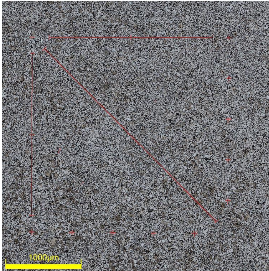
Figure IV-21 : Modèle pour déterminer la taille des grains
