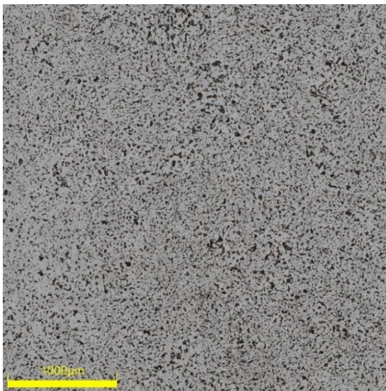
Figure IV-18 : Acier après traitement de normalisation, faible grossissement. Attaque Nital (5%), surface de 11mm 2
