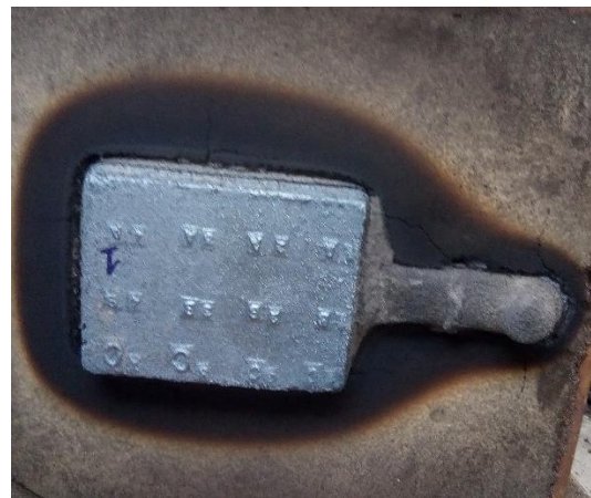
Figure III-13 : Exemple de lingot coulé avec nomenclature intégrée
