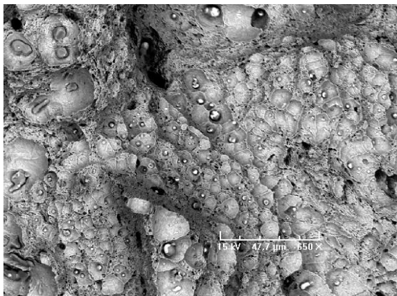
Figure V-38 : Faciès de rupture, essais de synthèse au lanthane, grossissement x650
