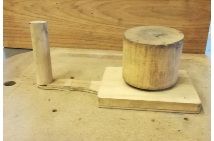
Figure III-15 : positionnement de la masselotte par rapport à la plaque-modèle
