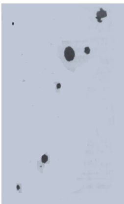
Figure IV-5 : Exemple d'inclusion de sulfure type I, x800 [12]
