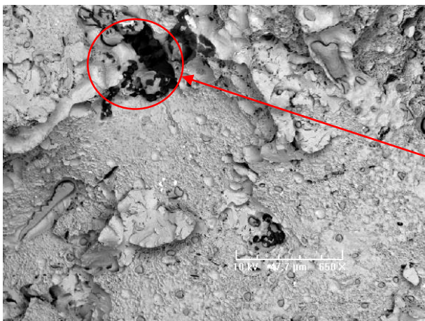
Figure V-33 : Faciès de rupture, premiers essais au FeSi (Si1), grossissement x650
