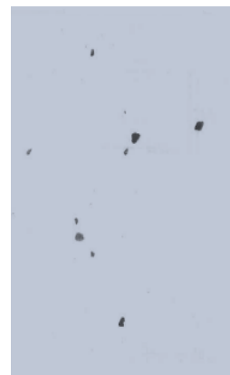
Figure IV-7 : Exemple d'inclusion de sulfure type III, x500 [12]
