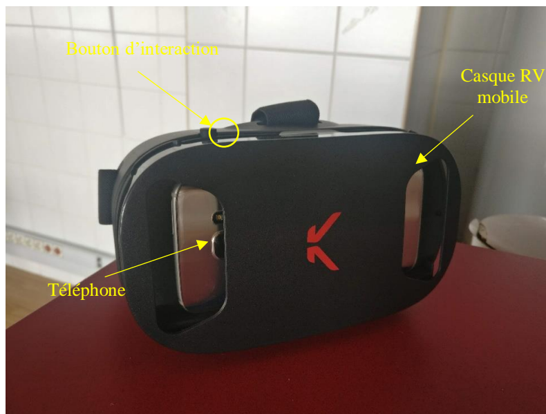
Figure 47 : Vue globale de l'espace de visualisation immersive, implémenté à l'aide d'un casque de réalité virtuelle pour mobile. Le bouton d'interaction se trouve en haut à gauche du casque.
