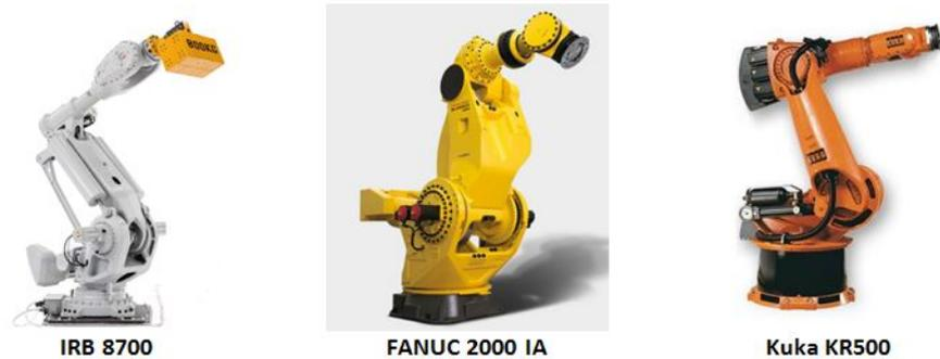
FIGURE 4.2 – Les robots industriels à fortes charges
