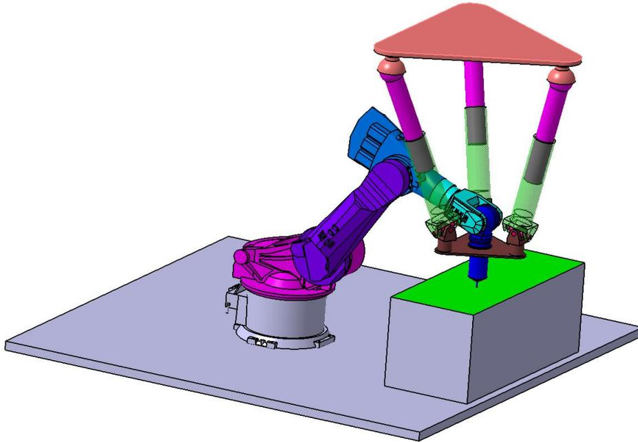
FIGURE 5.29 – La simulation du mécanisme hybride sous Catia
