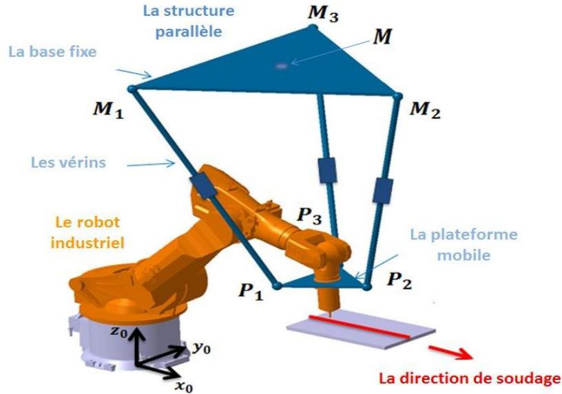
FIGURE 5.13 – La structure parallèle ajoutée au robot industriel
