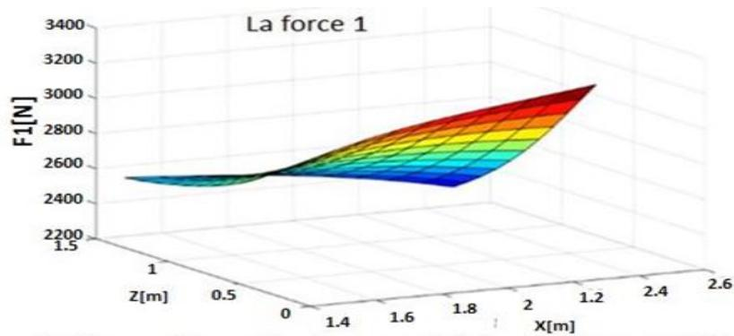
FIGURE 5.24 – La force créée par l'actionneur 1 de la structure parallèle
