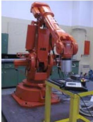
FIGURE 3.17 – Le système robotique développé par Smith pour le FSW [84]
