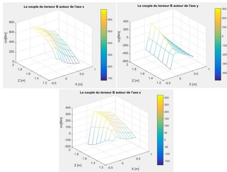
FIGURE 6.18 – Les couples créés par le robot B
