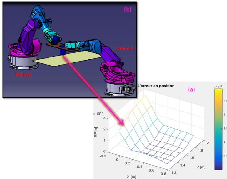
FIGURE 6.15 – (a) l'erreur en position avec  $d_{0A}=0.3$  m,  $d_{0B}=0.35$  m et  $l_{0A}=0.2$  m  $l_{0B}=0.15$  m, voir figure 6.7, (b) la position des robots A et B dans l'espace cartésien pour une valeur de l'erreur en position pour  $X=-0.1$  m et  $Z=1.4$  m
