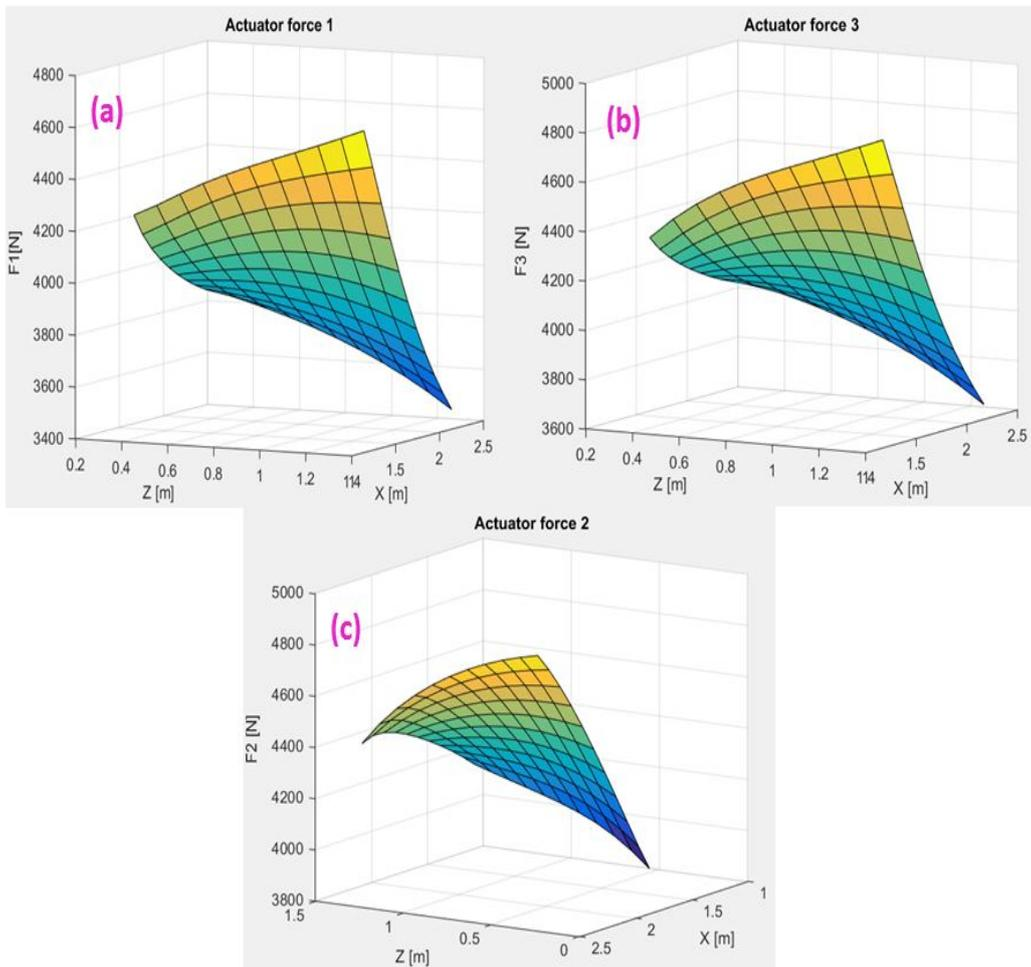
FIGURE 5.21 – Les forces créées par les trois actionneurs de la structure parallèle avec  $r_p = 0.3$ ,  $r_M = 1.2$ ,  $x_M = 1$ ,  $y_M = 0$  et  $z_M = 4$ , (a) La force créée par l'actionneur 1, (b) La force créée par l'actionneur 3, (c) La force créée par l'actionneur 2
