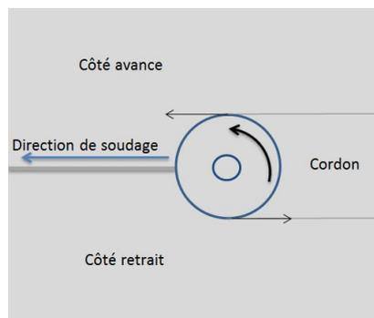
FIGURE 3.2 – Le côté avance et le côté retrait
