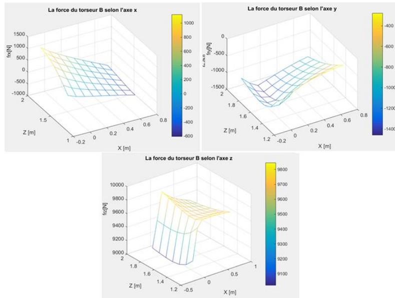
FIGURE 6.17 – Les forces créées par le robot B
