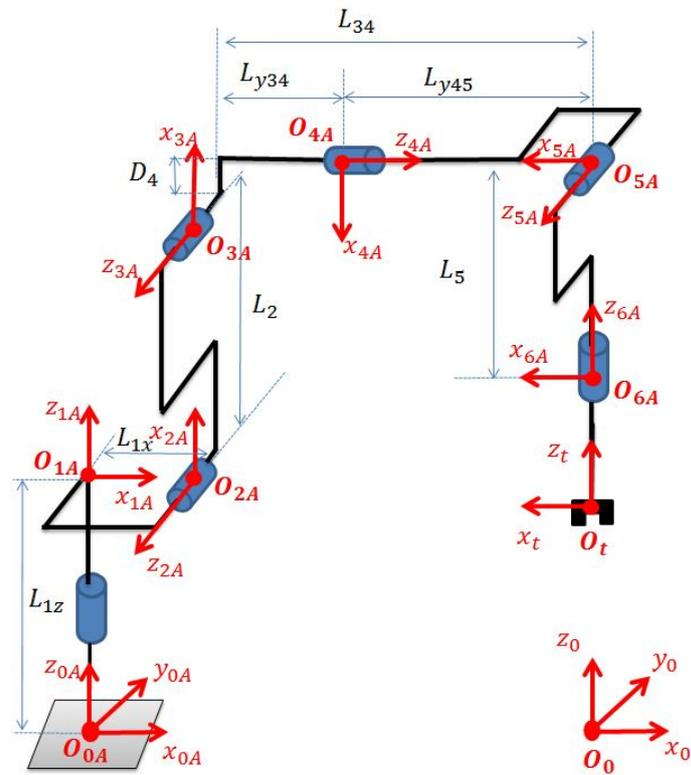
FIGURE 6.3 – Le schéma cinématique du robot A
