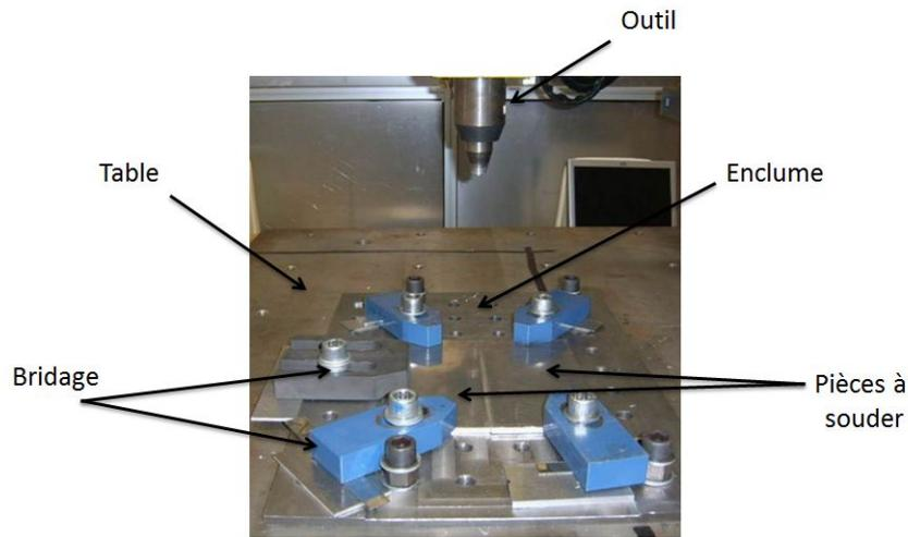
FIGURE 3.1 – Fixation des pièces à souder
