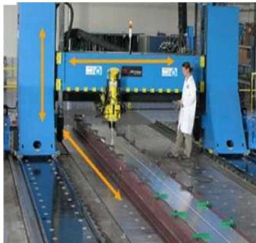
FIGURE 3.13 – Machine 5 axes de type portique MTS Machine
