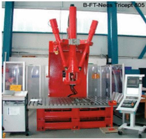
FIGURE 3.14 – Tricept TR805 utilisé en FSW [111]
