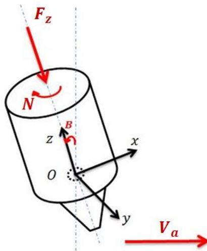
FIGURE 3.5 – Les paramètres du procédé FSW
