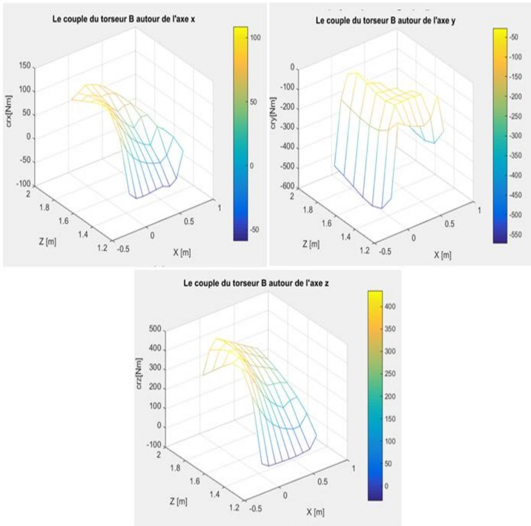
FIGURE 6.14 – Les couples créés par le robot B
