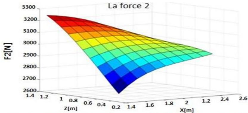
FIGURE 5.25 – La force créée par l'actionneur 2 de la structure parallèle
