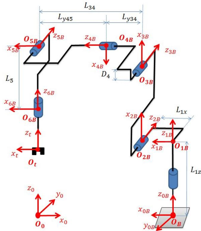
FIGURE 6.4 – Le schéma cinématique du robot B
