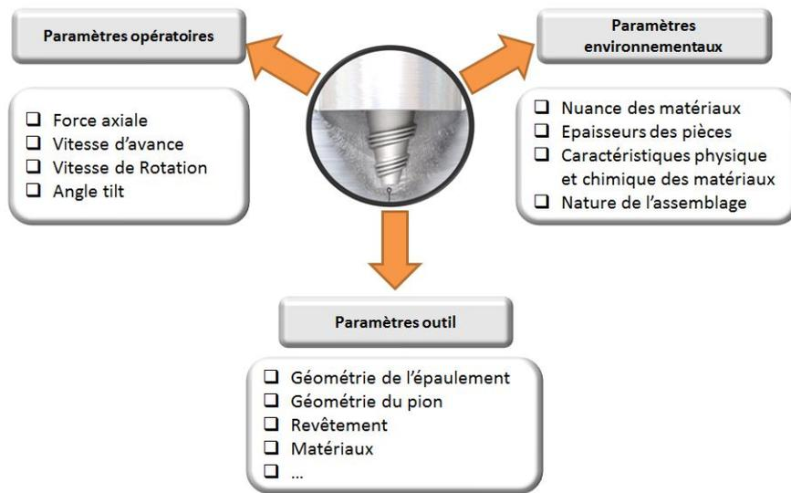
FIGURE 3.4 – Les paramètres du procédé FSW
