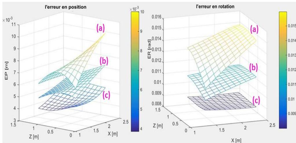
FIGURE 5.12 – L'influence de la masse ajoutée sur les deux critères : (a) est l'erreur sans masse, (b) est l'erreur avec  $M7= 400$  kg, (c) est l'erreur avec une masse de  $M7= 700$  kg
