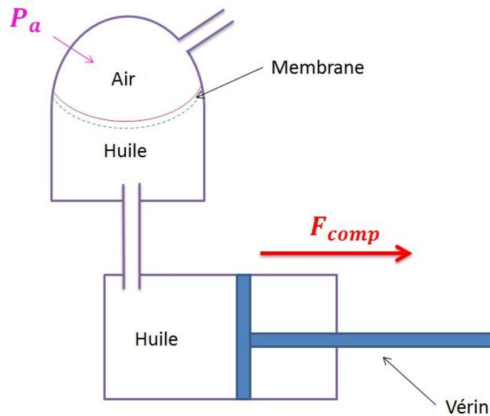
FIGURE 4.11 – Le compensateur de gravité à vérin à gaz
