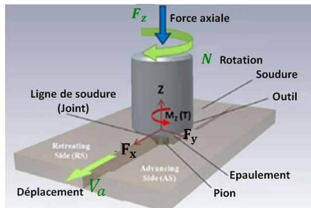
FIGURE 3.3 – Le principe du procédé FSW [38]
