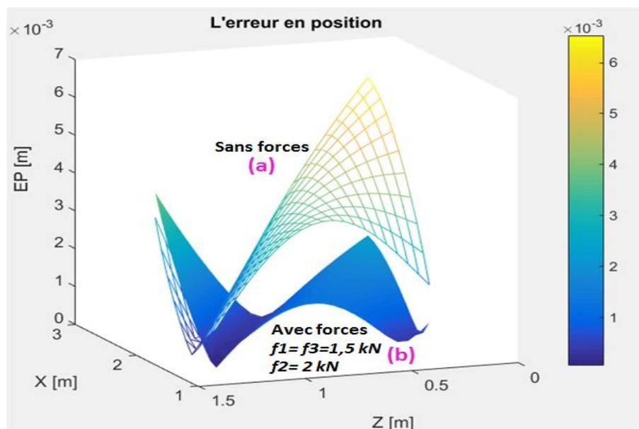
FIGURE 5.17 – l'influence des forces appliquées par la structure parallèle sur l'erreur en position, (a) : l'erreur en position sans les forces, (b) : l'erreur en position avec  $f_1 = f_3 = 1,5$  kN et  $f_2 = 2$  kN
