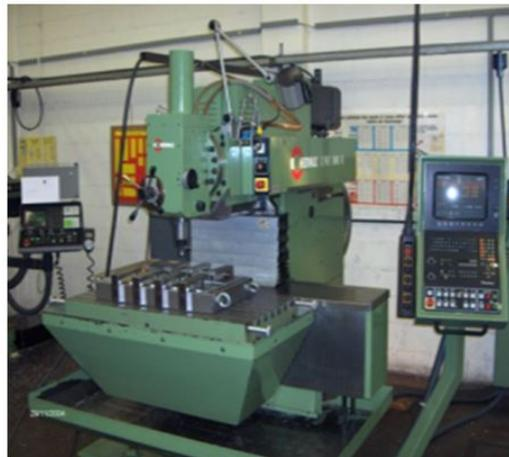
FIGURE 3.12 – Fraiseuse adaptée pour le FSW, à UCL-PRM
