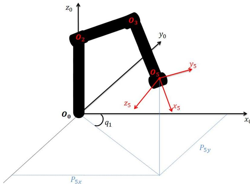
FIGURE 8.3 – L'angle de la première articulation du robot
