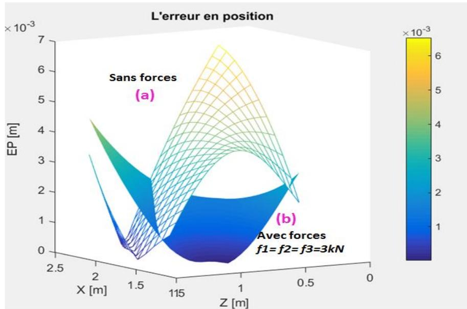
FIGURE 5.18 – l'influence des forces appliquées par la structure parallèle sur l'erreur en position, (a) : l'erreur en position sans les forces, (b) : l'erreur en position avec  $f_1 = f_2 = f_3 = 3 \text{ kN}$
