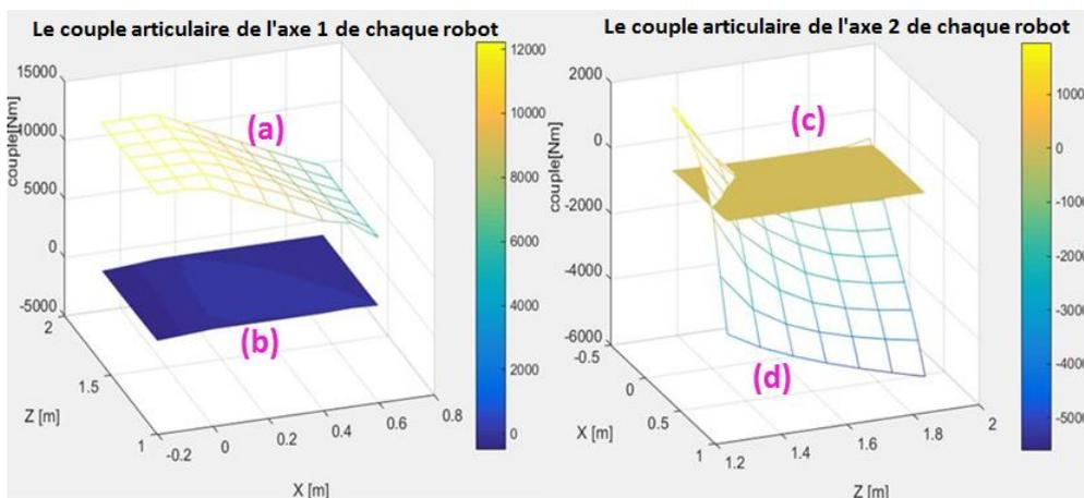
FIGURE 6.22 – les couples articulaires des axes 1 et 2 du robot A et B après l'optimisation, (a) le couple articulaire de l'axe 1 du robot B, (b) le couple articulaire de l'axe 1 du robot A, (c) le couple articulaire de l'axe 2 du robot A, (d) le couple articulaire de l'axe 2 du robot B
