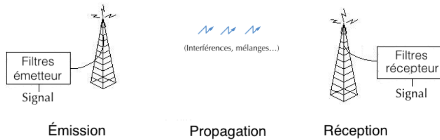
FIGURE 1.1: Schématisation de la propagation d'une onde magnétique entre une antenne émettrice et une antenne réceptrice.
