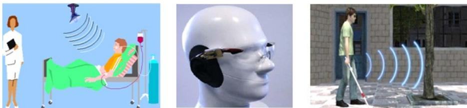
FIGURE 1.2 – Applications bien-être de Radar UWB pour le grand public : application à la mesure du rythme respiratoire à courte portée et applications à la détection d'obstacles devant le malvoyant avec une intégration sur des lunettes ou une canne.
