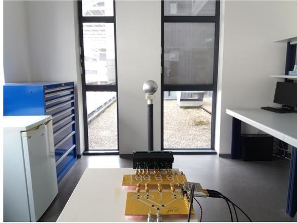
FIGURE 4.29 – Photo du site de mesure avec la sphère.
