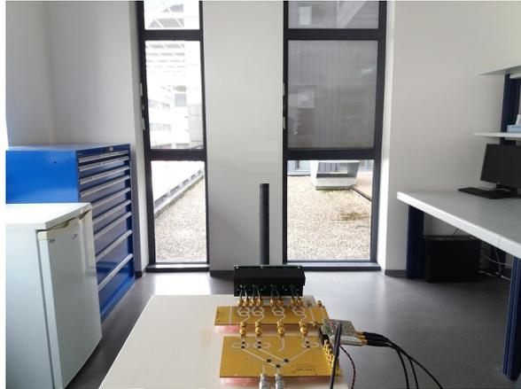
FIGURE 4.38 – Photo du site de test avec un poteau en plastique à 2 m et à la direction  $0^{\circ}$
