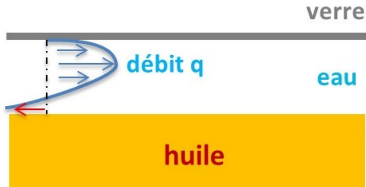
FIGURE 71 : Profil parabolique de la vitesse radiale dans le film pour \beta < 1
