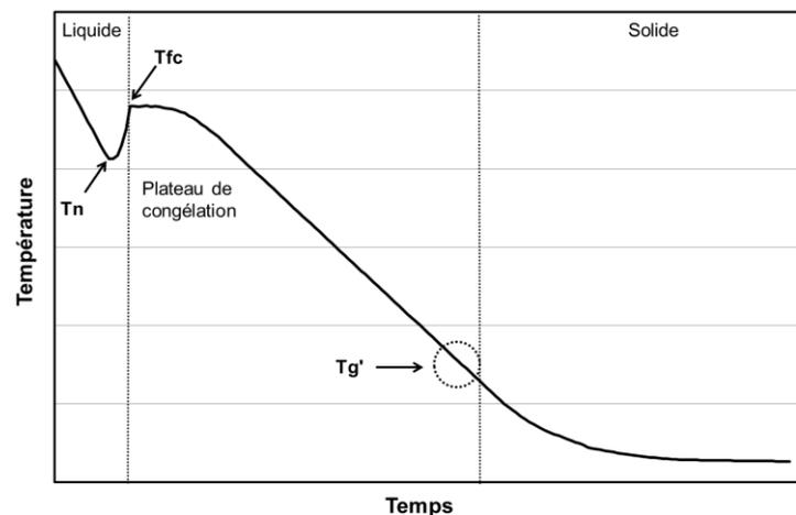
Figure I.10 Profil de température du produit et principaux événements ayant lieu lors de la congélation d'un concentré bactérien.  $T_n$ , température de nucléation ;  $T_{fc}$ , température de fusion commençante ;  $T_g'$ , température de transition vitreuse.
