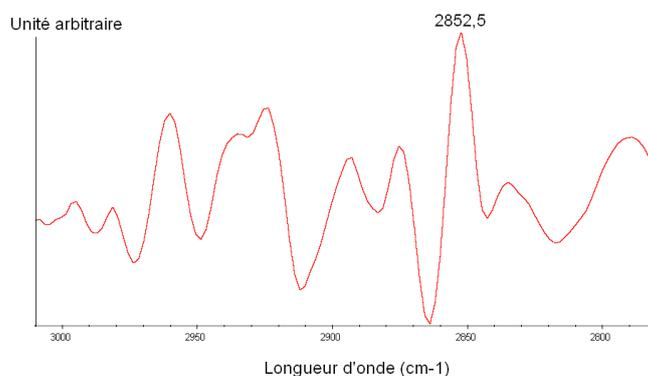
Figure II.9 Représentation entre  $3000\text{ cm}^{-1}$  et  $2800\text{ cm}^{-1}$  de la dérivée seconde lissée et inversée d'un spectre infrarouge obtenu avec un culot cellulaire de *L. lactis* TOMSC161.
