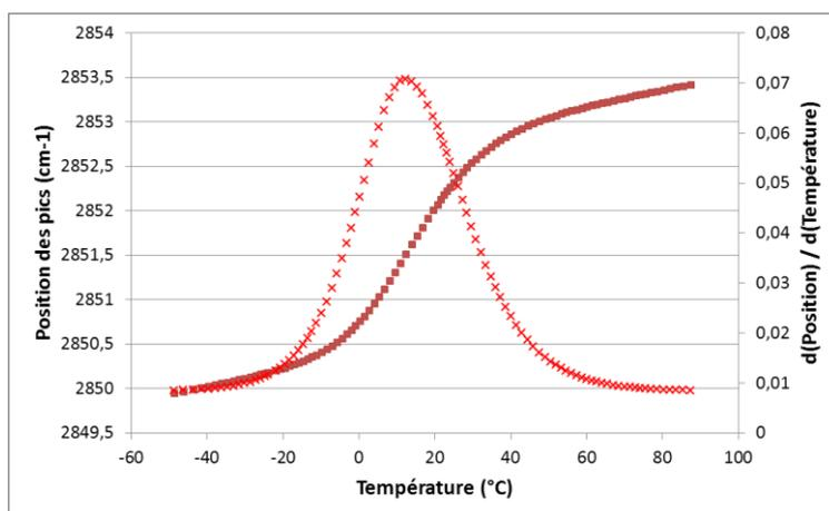
Figure II.10 Variation de la longueur d'onde du pic correspondant aux vibrations de valence symétrique des groupes CH<sub>2</sub> (en cm<sup>-1</sup>) en fonction de la température (en °C) et de sa dérivée première (en cm<sup>-1</sup>.°C<sup>-1</sup>), avec un culot cellulaire de *L. lactis* TOMSC161
