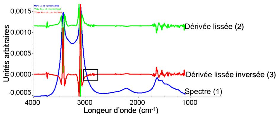
Figure II.8 Représentation d'un spectre (1) correspondant à l'analyse d'un culot cellulaire de *L. lactis* TOMSC161, de sa dérivée seconde lissée (2) et inversée (3)
