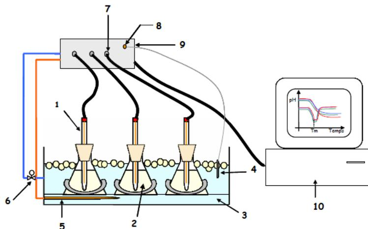
Figure II.5 Schéma simplifié du dispositif CinAc<sup>®</sup>. 1, électrode de pH ; 2, fiole contenant du laitensemencé ; 3, bain-marie thermostaté ; 4, sonde de température ; 5, résistance chauffante ; 6, électrovanne d'admission d'eau froide ; 7, transmetteur de pH ; 8, transmetteur de température ; 9, interface électronique ; 10, ordinateur. D'après Wang (2005).
