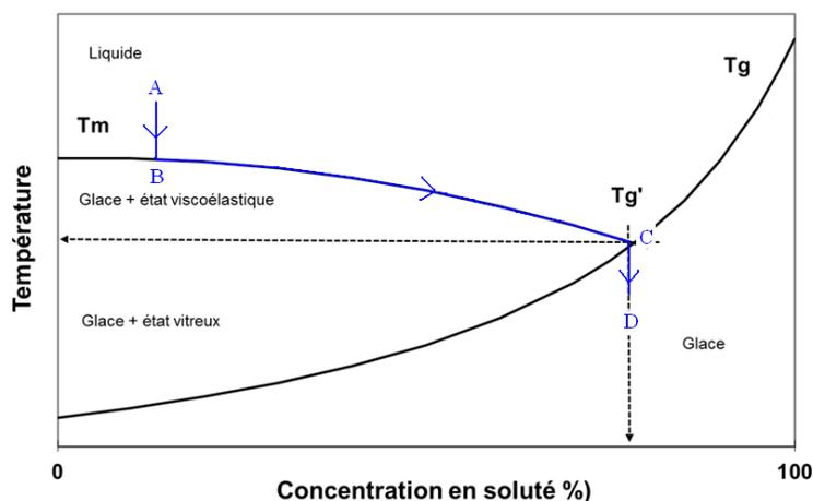
Figure I.12 Diagramme d'état montrant l'évolution du concentré bactérien au cours de la lyophilisation (A à D : congélation).  $T_g$  et  $T_g'$ , température de transition vitreuse ;  $T_m$ , température de fusion.
