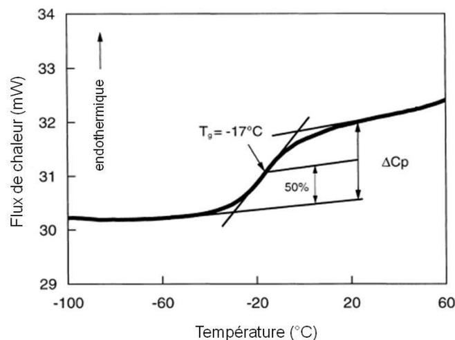
Figure II.17 Evolution du flux de chaleur ( $dQ/dt$ ) en fonction de la température, mesurée par analyse calorimétrique différentielle. La température de transition vitreuse ( $T_g$ ) correspond au point d'inflexion de la courbe. D'après Fonseca *et al.* (2001b).
