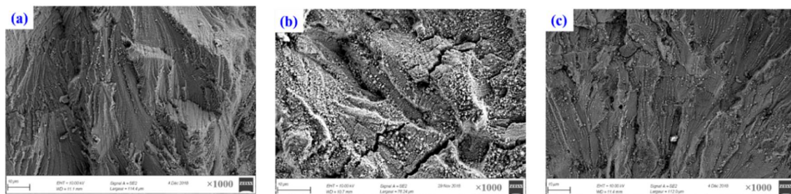
Figure III.44 : Image MEB des faciès de rupture des éprouvettes testées en fatigue équi-biaxiale dans l'eau distillée en conditions REP
