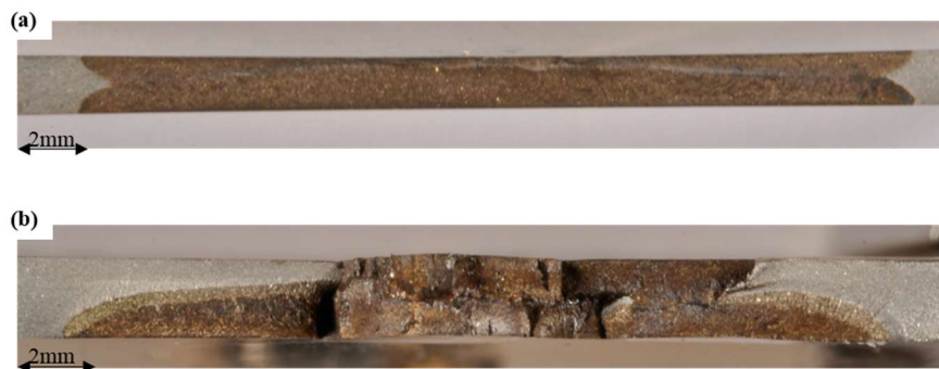
Figure III.23 : Faciès de rupture après sollicitation dans l'eau distillée à la température ambiante (a) : 743B-L (LVDT = 1,1 mm) (b) : 743B-G (LVDT = 1,4 mm)
