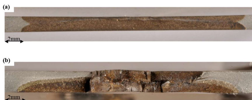
Figure III.23 : Faciès de rupture après sollicitation dans l'eau distillée à la température ambiante (a) : 743B-L (LVDT = 1,1 mm) (b) : 743B-G (LVDT = 1,4 mm)
