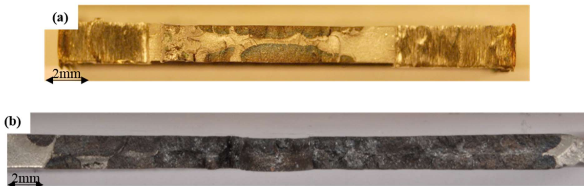
Figure III.32 : Faciès de rupture après sollicitation dans l'eau distillée en conditions REP : 743B-J (LVDT = ±1,1 mm) (b) : 743B-D (LVDT = ±1,4 mm)
