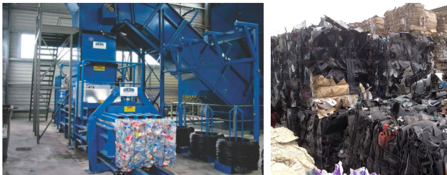
Figure 55 : presse à balles et balles de pare-chocs
