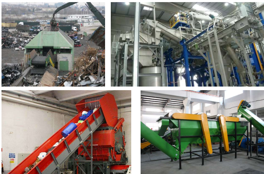
Figure 44 : ressources de broyage et tri d'un broyeur VHU (haut) et d'un broyeur-flotteur (bas)
