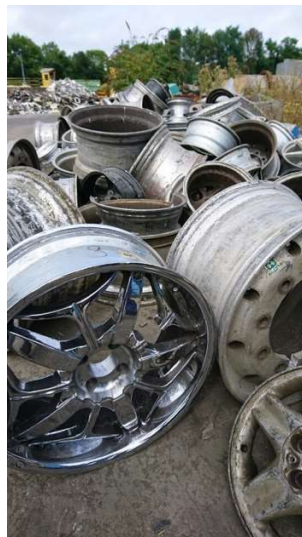
Figure 31 : hétérogénéité d'un gisement typique de jantes en aluminium
