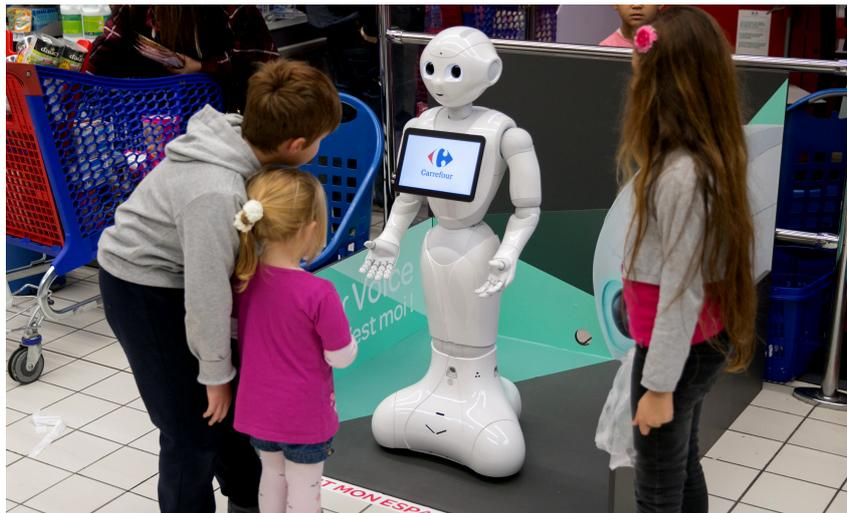
FIGURE 1.3: Pepper divertissant des enfants dans un magasin Carrefour. Bien que le robot soit équipé d'une base holonome, ce dernier est utilisé de manière statique. Cette utilisation vient du fait que le robot ne sait pas estimer correctement sa pose.
