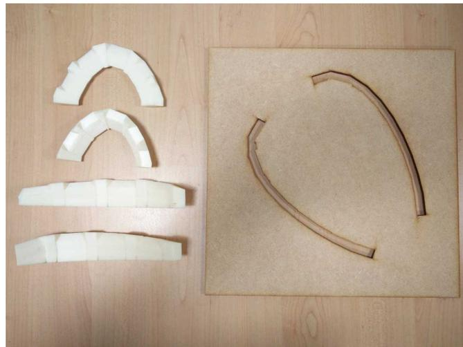
FIGURE 5.32 – À gauche : sous-ensembles de blocs formant la frontière de la voûte. À droite : base en MDF.
