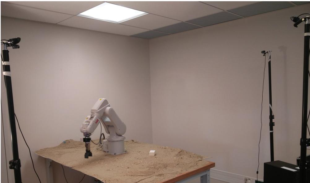
FIGURE 6.7 – Acquisition d’images réelles pour créer notre base de données d’évaluation, avec trois caméras à des positions arbitraires et changeantes.
