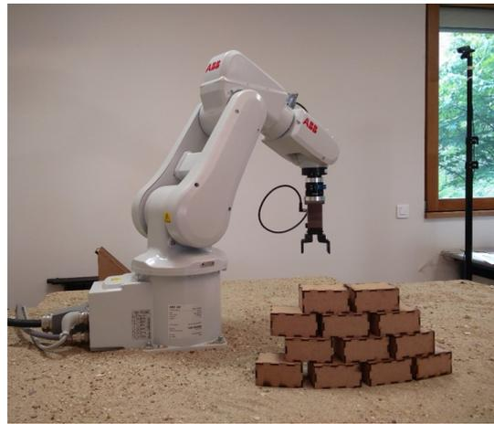
(b) Mur construit en utilisant notre algorithme de vision artificielle pour la localisation et l'estimation de pose des blocs.
