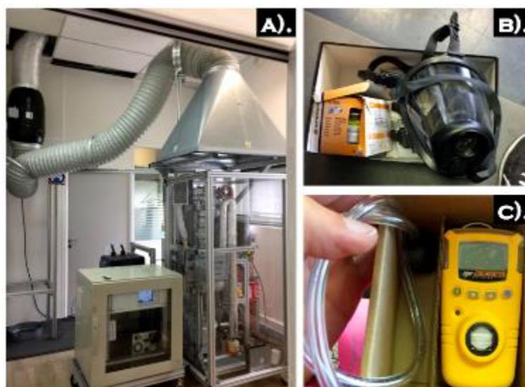
**Figure 3.22.** Mesures de sécurité additionnelles pour la manipulation de SO<sub>2</sub> : A). Système de ventilation générale et enclos d'isolation en polycarbonate ; B). Masque de protection avec filtre spécial ; C). Détecteurs de SO<sub>2</sub>
