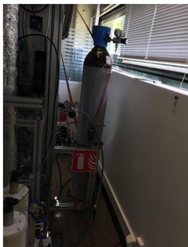
**Figure A6.3.** Photo du cylindre de SO<sub>2</sub> et son placement à côté d'A.D.E.S.
