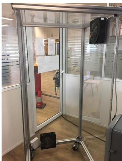
**Figure A6.1.** Photo de la cage en polycarbonate, équipée des ventilateurs, du système A.D.E.S.
