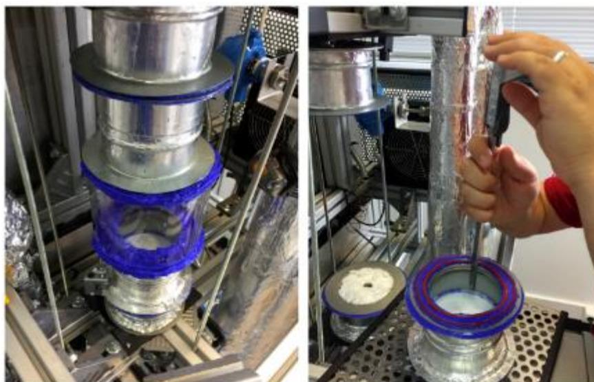
**Figure 3.23.** Description en photos de la méthode expérimentale de la méthode d'évaluation du phénomène de fluidisation
