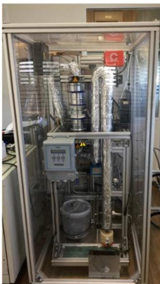
**Figure 3.18.** Photographies du banc d'essai A.D.E.S., de l'unité de caractérisation de gaz (NDIR) et de la ventilation générale mise en place dans le laboratoire.
