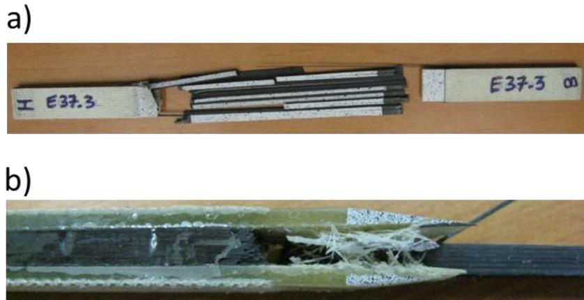
Figure I-13 : Exemples de ruptures prématurées des éprouvettes  $[0^\circ]_{16}$ .
