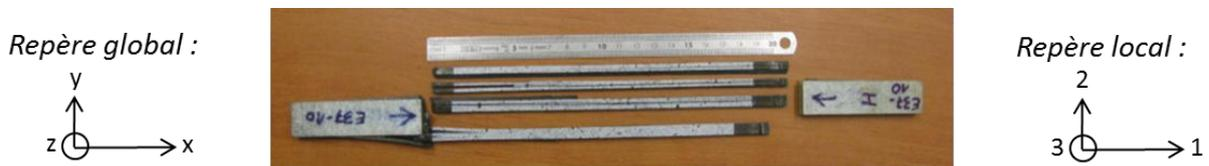
Figure I-1 : rupture par splitting d'un UD  $[0^\circ]_{16}$  sollicité en traction axiale longitudinale.
