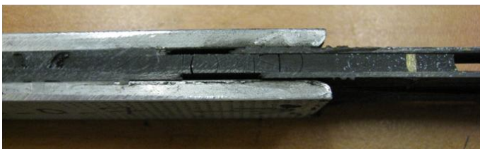
Figure IV-17 : Faciès de rupture de l'éprouvette P3-0-7 ( \Sigma_L^{\text{MAX}} = 0.85 \Sigma_L^{\text{R}} , R = 0.1 , DDV = 477\ 000 cycles).
