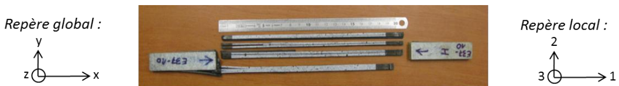
Figure I-1 : rupture par splitting d'un UD [0^\circ]_{16} sollicité en traction axiale longitudinale.
