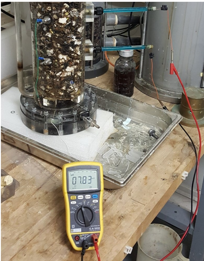
Figure 43 : Mesure PS sur une colonne de déchet avec un multimètre haute impédance
