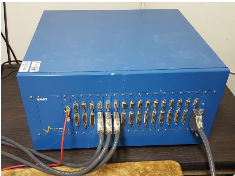
Figure 47 : Photo du potentiostat VMP3 de Biologic utilisé pour les mesures PPS
