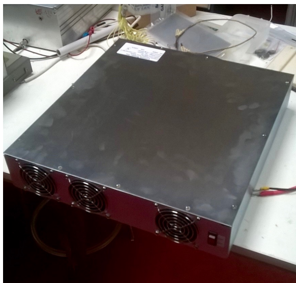
FIGURE 6.9 – Chargeur de condensateurs modèle CCPJ-2000-XX 15 kV.
