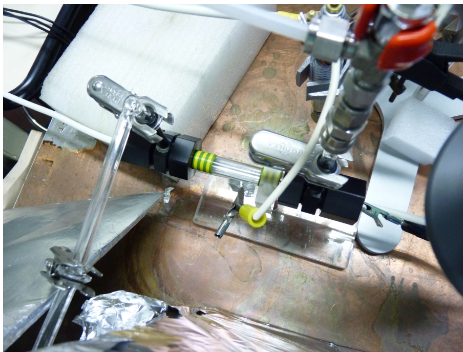
FIGURE 5.2 – Détail du réacteur utilisé pour l'étude de la destruction de faibles concentrations d'éthanol par plasma non-thermique.
