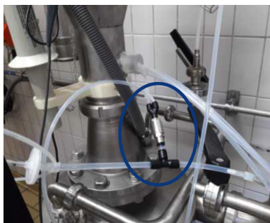
FIGURE 7.18 – Connecteurs utilisés pour les prélèvements en aval du premier module DBD.
