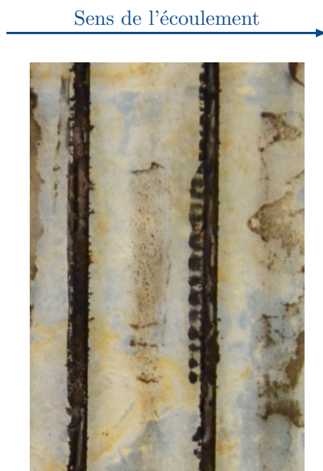
FIGURE 7.29 – Détail des traces de décharges sur la plaque de verre.
