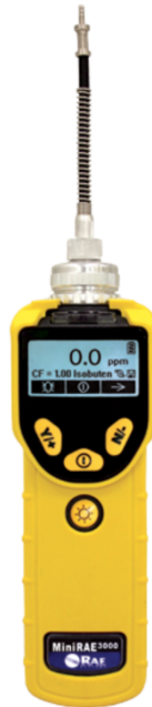
FIGURE 7.2 – Détecteur de composés organiques volatils à photo-ionisation MiniRAE 3000 utilisé pour des mesures in situ et en temps réel.
