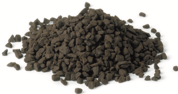
FIGURE 6.10 – Granules du catalyseur utilisé, commercialisé sous le nom de Moleculite par Molecular Products Limited [118].
