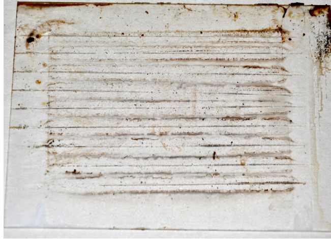
FIGURE 7.30 – Plaque de diélectrique utilisée dans le réacteur RECOVER, avec les traces des électrodes et des traces de dépôts qui délimitent la zone d'action des décharges.
