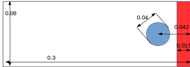
FIGURE 4.30 – Configuration du cas test 2D d'un choc heurtant une bulle d'hélium
