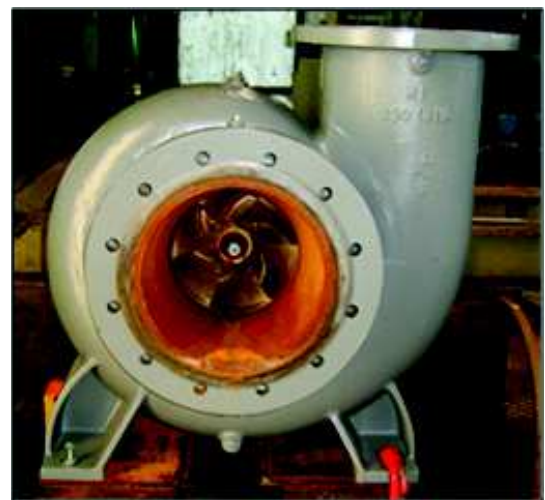
FIGURE 4.8 – Photo de la pompe ME250315 du Cetim Nantes
