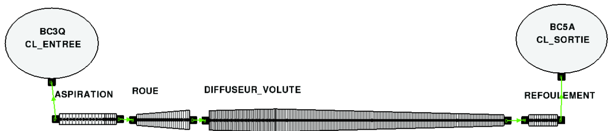
FIGURE 4.12 – Modélisation 1D appliquée à la pompe DERAP (sections méridiennes)
