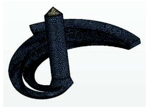
FIGURE 4.63 – Maillage de 1/5 ème de l'aspiration, roue et diffuseur de DERAP (issu de [ES18])
