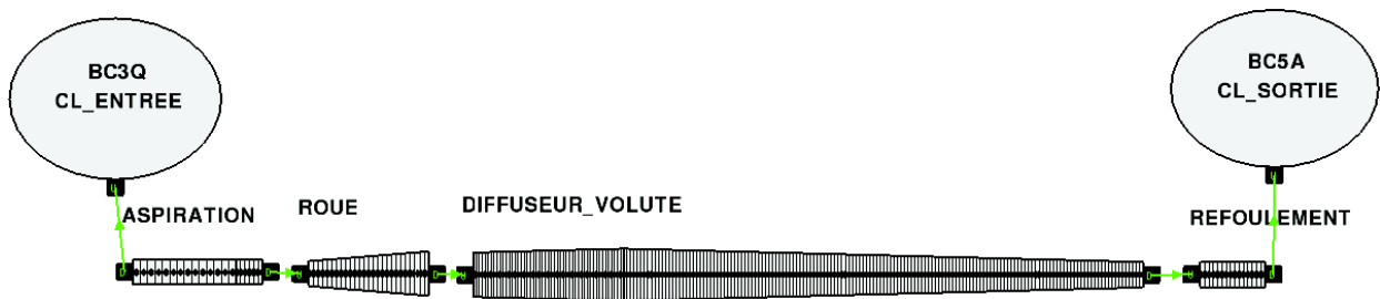
FIGURE 3.3 – Modélisation 1D appliquée à la pompe DERAP
