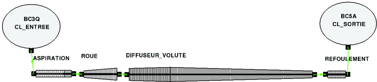
FIGURE 3.3 – Modélisation 1D appliquée à la pompe DERAP
