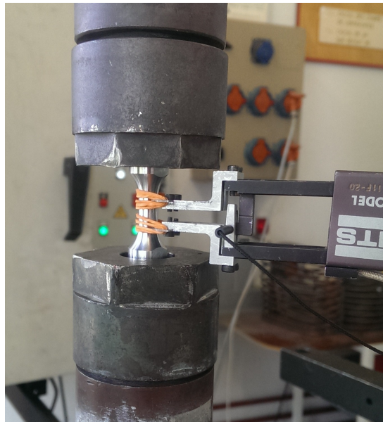
FIGURE 4.25 – Montage d'une éprouvette oligocyclique avec capteur de déformation.
