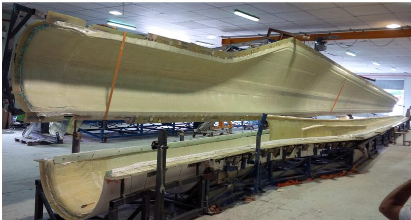
Figure I.14 : Assemblage de la pale prototype G2 (25 m) réalisée dans le cadre du projet EFFIWIND
