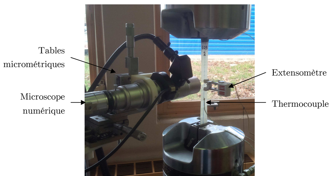
Figure II.9 : Montage expérimental utilisé dans ce travail pour l'observation de l'endommagement sur le chant des éprouvettes
