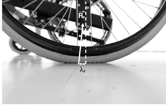
Figure 1.11 – Photographie illustrant la déformation de la roue et le paramètre de résistance au roulement [Sauret et al., 2012]
