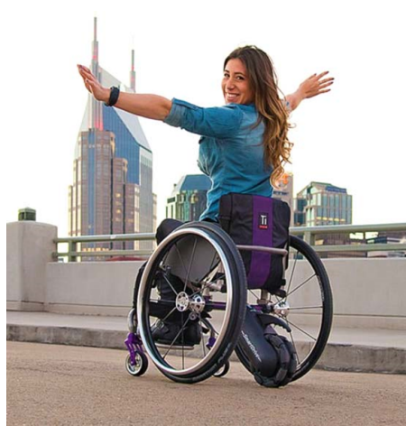
(b) fauteuil roulant actif actuel, personnalisé et équipé d'une roue motrice d'assistance à la propulsion. Image issue de la fiche produit SmartDrive de Permobil
