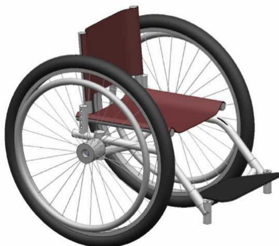
Figure 1.1 – Représentation de l'ensemble châssis, roues arrière et système de soutien du corps (dossier, assise, repose-pieds)
