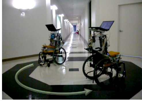
Figure 1.20 – Photographie du robot simulateur de propulsion en FRM avec trajectoire circulaire basé sur le modèle de [Teran and Ueda, 2017]
