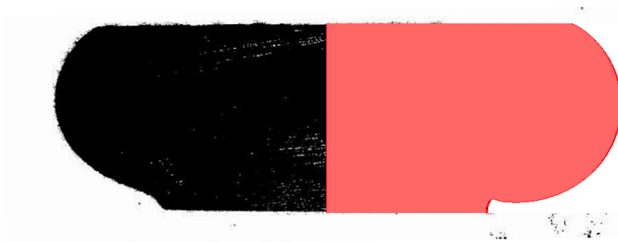
Figure 57 Profil réel (à gauche) et simulé (à droite) du lopin d'Inconel après compression sous presse à vis à 1200°C avec les paramètres thermiques de la base de données.
