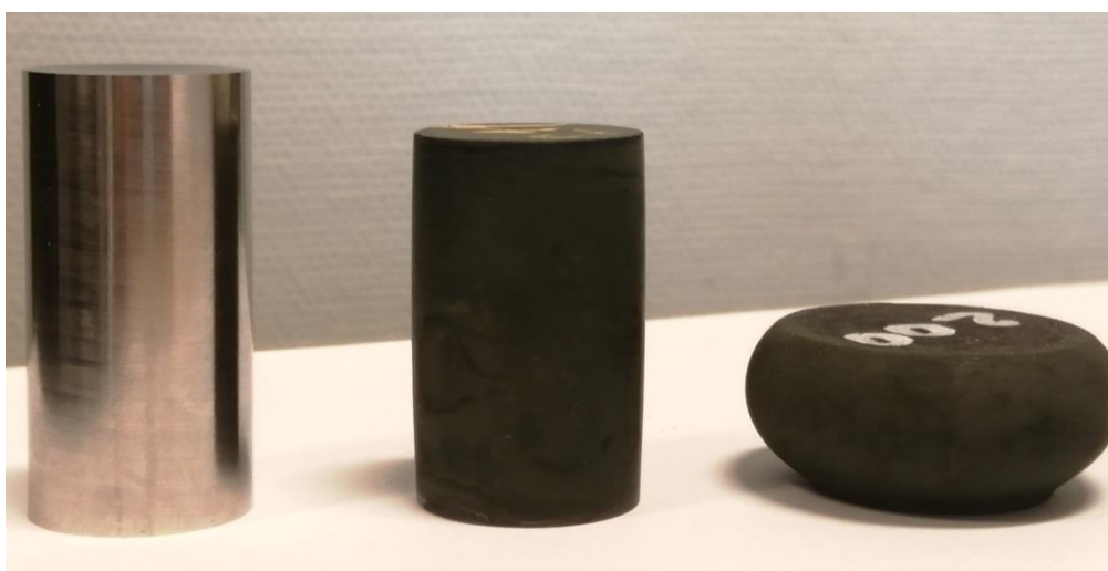
Figure 64 Gauche : lopin non déformé ; milieu : déformation de 15% pour l'étude de la recristallisation statique ; droite : Déformation de 60% pour l'étude de la recristallisation dynamique et métadynamique.
